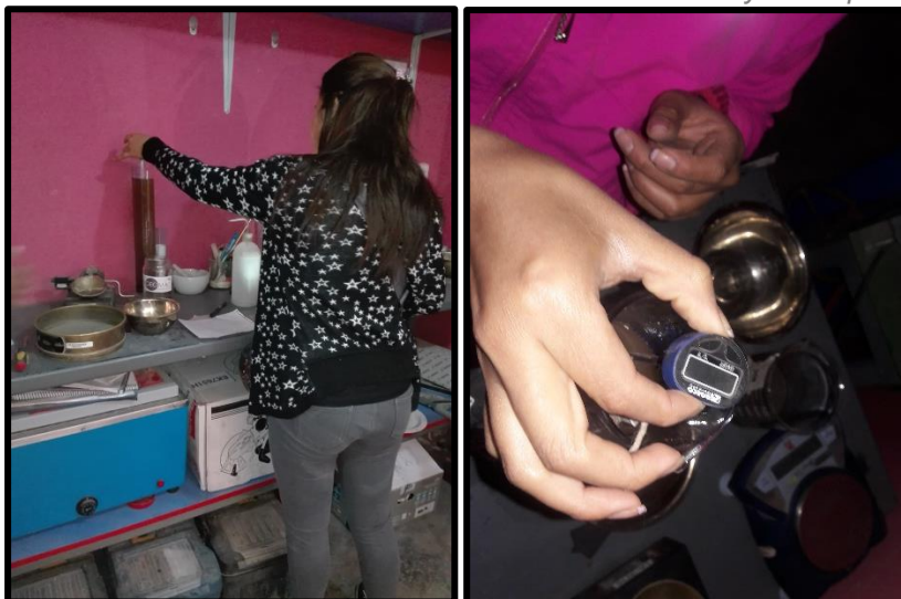
FIGURA N° 43: Toma de la lectura del hidrómetro y la temperatura.
