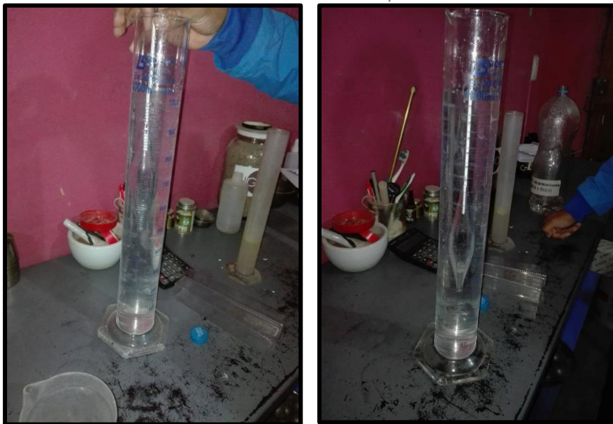
FIGURA N° 44: Lecturas del hidrómetro para la corrección de cero.
