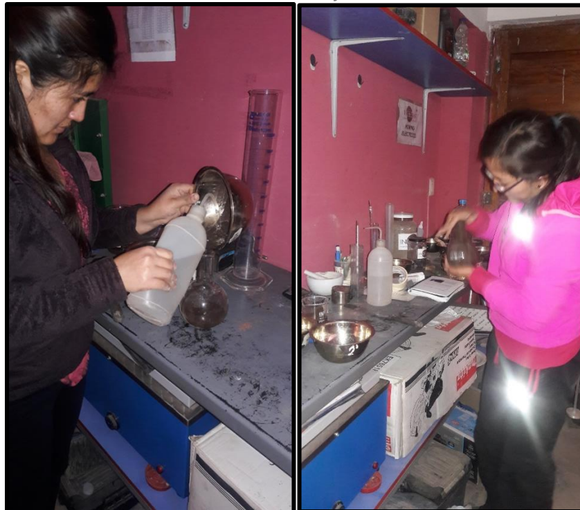
FIGURA N° 41: Transferir la muestra y batir durante 1 min.
