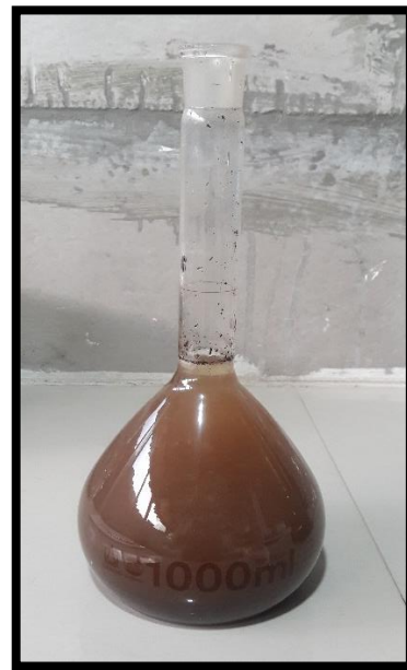
FIGURA N° 46: Muestra n° 03 del suelo en el picnómetro con agua.
