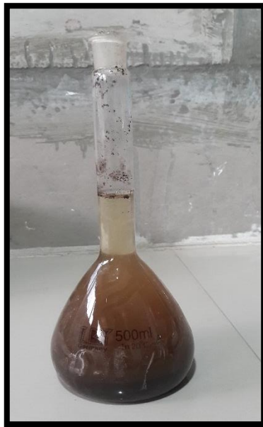
FIGURA N° 45: Muestra n° 02 del suelo en el picnómetro con agua.
