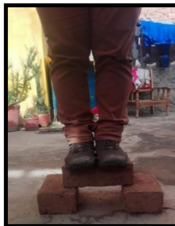
Figura N° 70: Prueba de Flexión en Campo Fuente propia.
