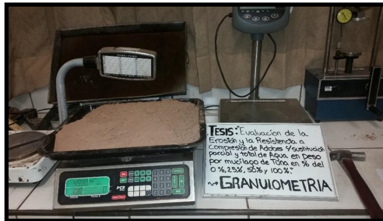
Figura N° 83: Peso del Suelo Seco Seleccionado. Fuente propia.
