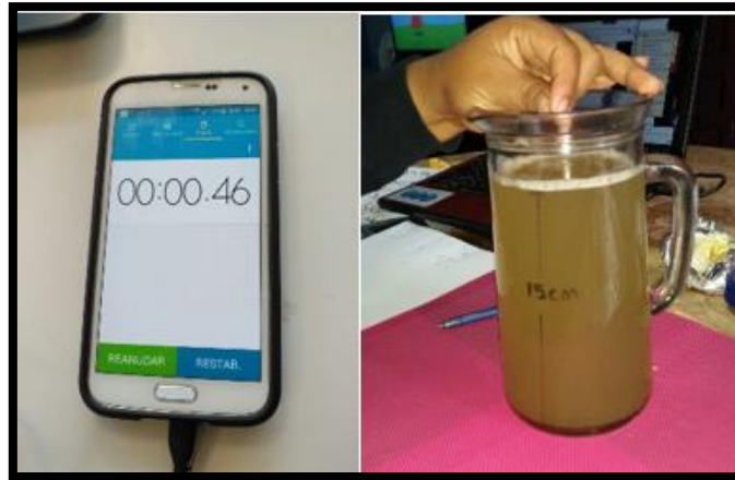
Figura N° 121: Toma de Tiempo que Transcurre la Canica en Llegar al Fondo Fuente propia.
