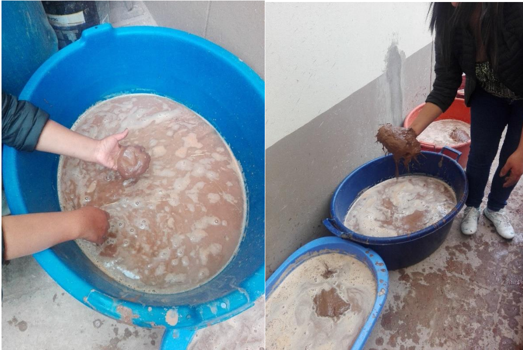
Desintegración de Adobes con 0% de Mucílago de Tuna
