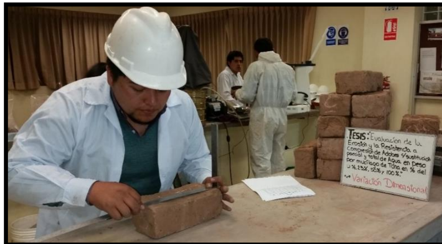
Figura N° 99: Medida de las Alturas de los Adobes Fuente propia.
