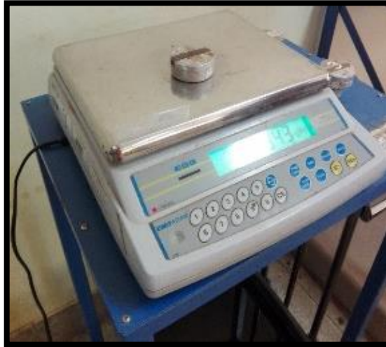
Figura N° 71: Peso de la Capsula de Aluminio Vacío Fuente propia.
