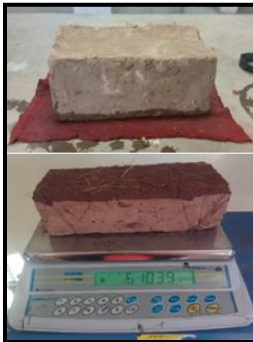
Figura N° 110: Secado del Espécimen y Registro del Peso del Testigo al Concluir la Prueba de Succión. Fuente propia.
