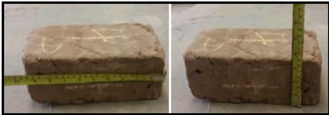
Figura N° 107: Medición de la Variación de Dimensión de las Unidades de Adobes Para el Ensayo de Absorción.
