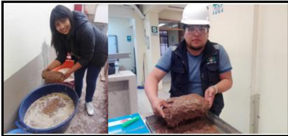
Figura N° 104: Retirado de los Especímenes del Baño. Fuente propia.
