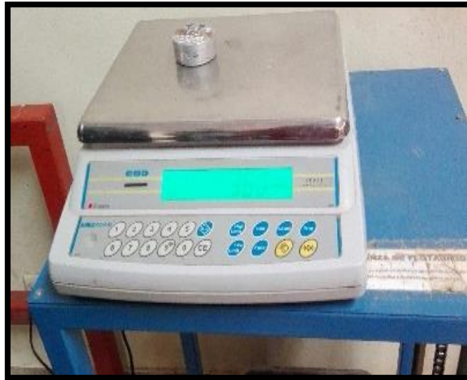
Figura N° 73: Peso del Suelo Seco más el Peso del Recipiente. Fuente propia.
