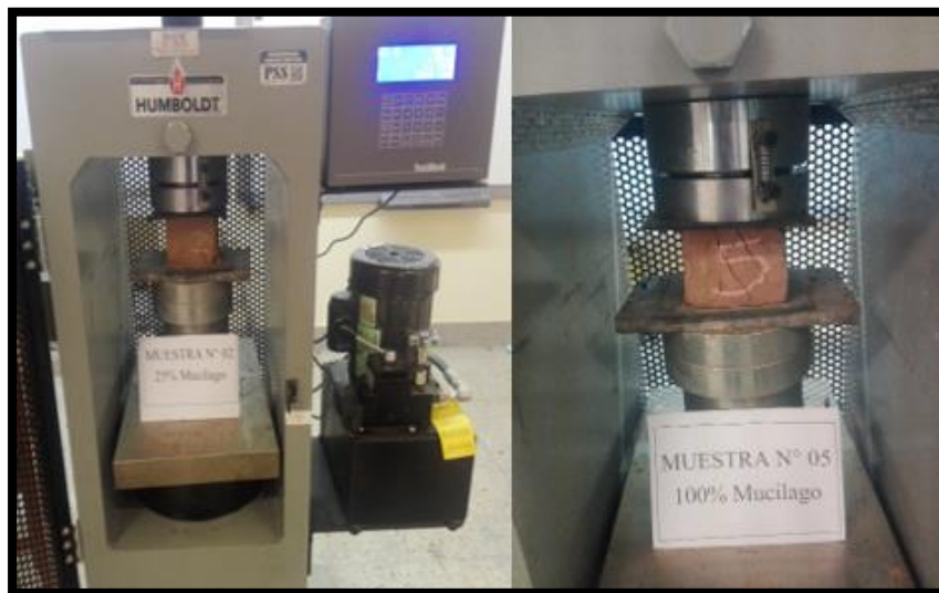
Figura N° 113: Falla del testigo Expuesto a Compresión. Fuente propia.
