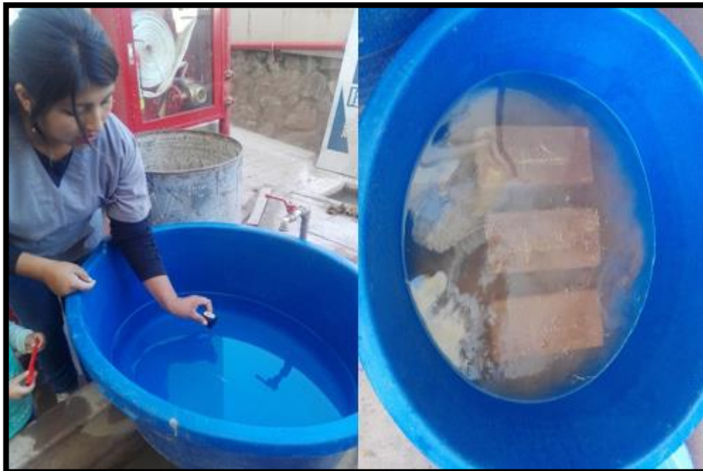
Figura N° 103: Medida de la Temperatura del agua, Testigos Sumergido Fuente propia.
