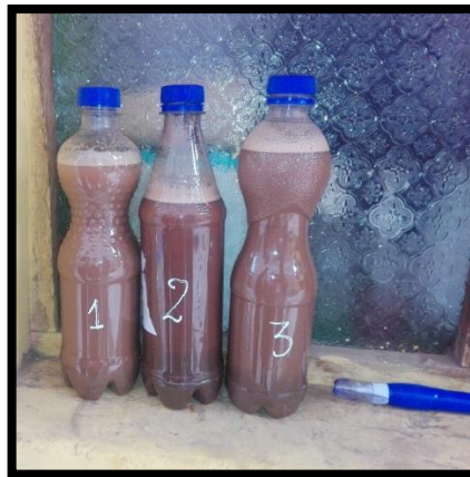
Figura N° 68: Prueba de la Botella. Fuente propia.
