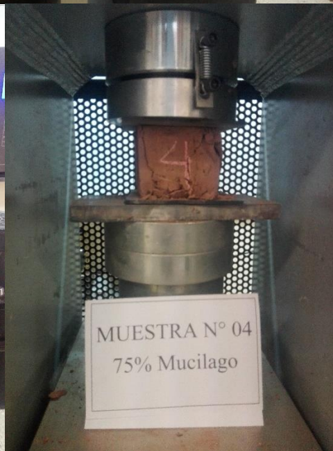
Ensayo de Compresión en Adobes en Unidades Cúbicas.
