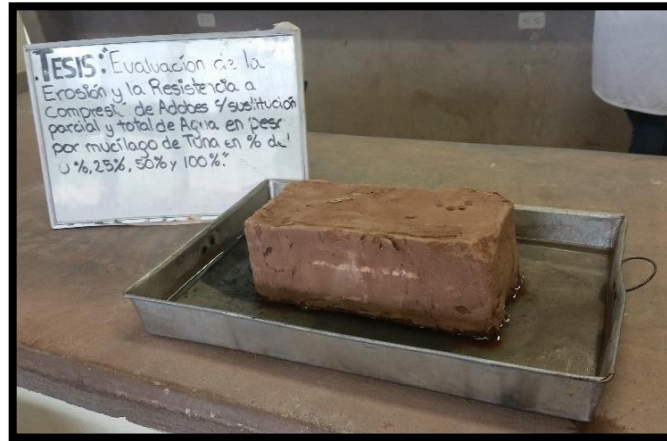
Figura N° 109: Prueba de Succión del Testigo de Adobe Durante 1 Minuto. Fuente propia.
