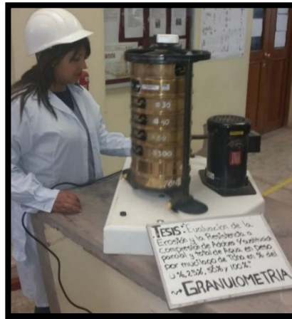
Figura N° 85: Tamizado del Suelo Seco. Fuente propia.
