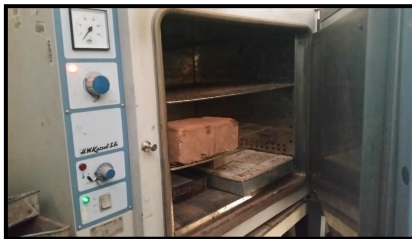
Figura N° 101: Secado de las Unidades de Adobes en el Horno Durante 24 Hrs. Fuente propia.
