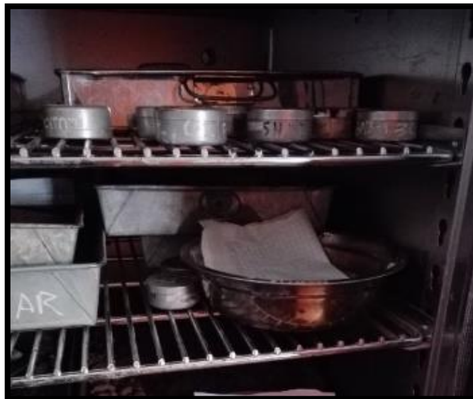
Figura N° 72: Colocado y Secado de la Muestra del Suelo Húmedo en el Horno Fuente propia.
