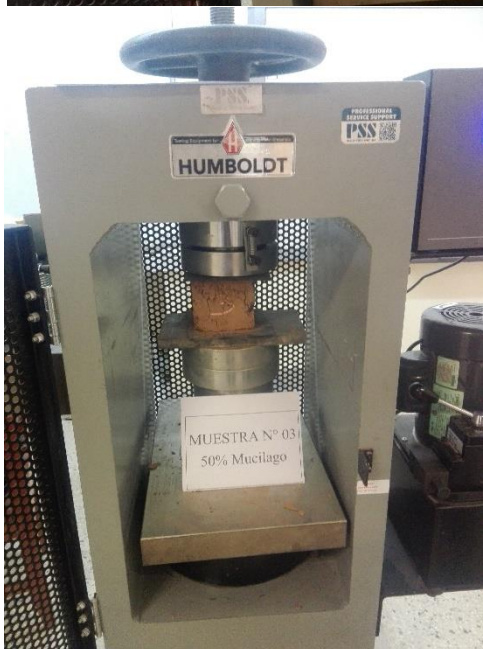
Ensayo de Compresión en Adobes en Unidades Cúbicas.
