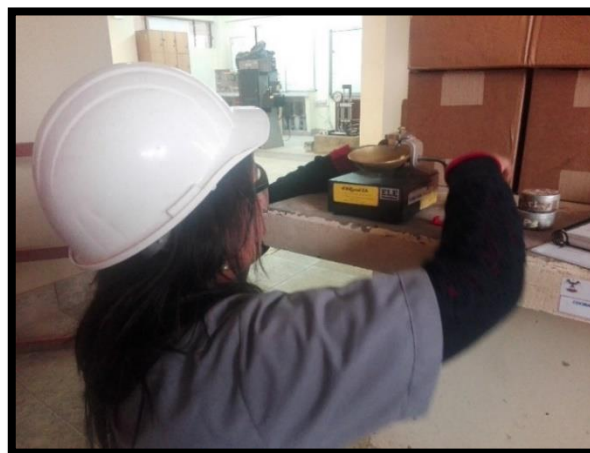
Figura N° 76: Ajustado del Aparato de Límite Líquido Fuente propia.
