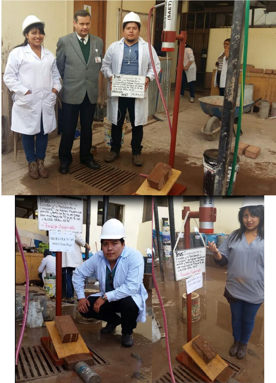
Ensayo de Erosión Acelerada de Swinburne en Adobes.
