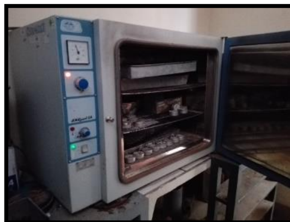
Figura N° 84: Secado en Horno a 110°C del Suelo Lavado. Fuente propia.
