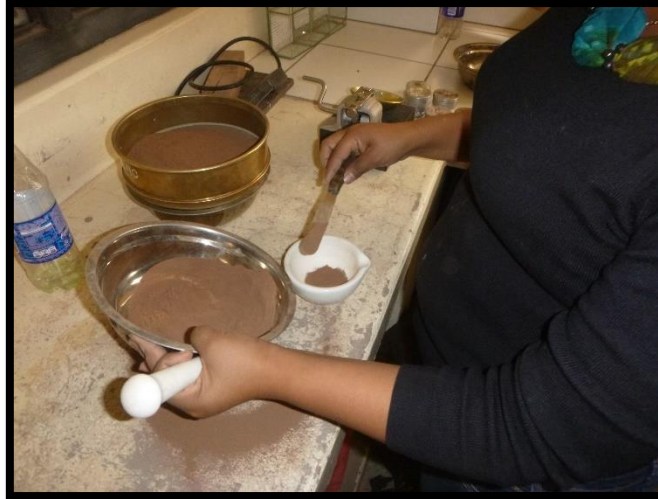
Figura N° 77: Mezclado del Suelo con Agua Fuente propia.
