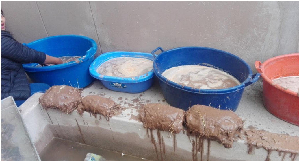
Desintegración de los adobes con 25% y 50% después de 24 horas
