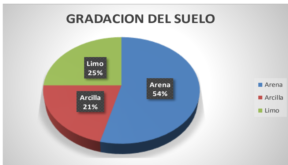
Figura N° 126: Gradación del Suelo. Fuente propia.
