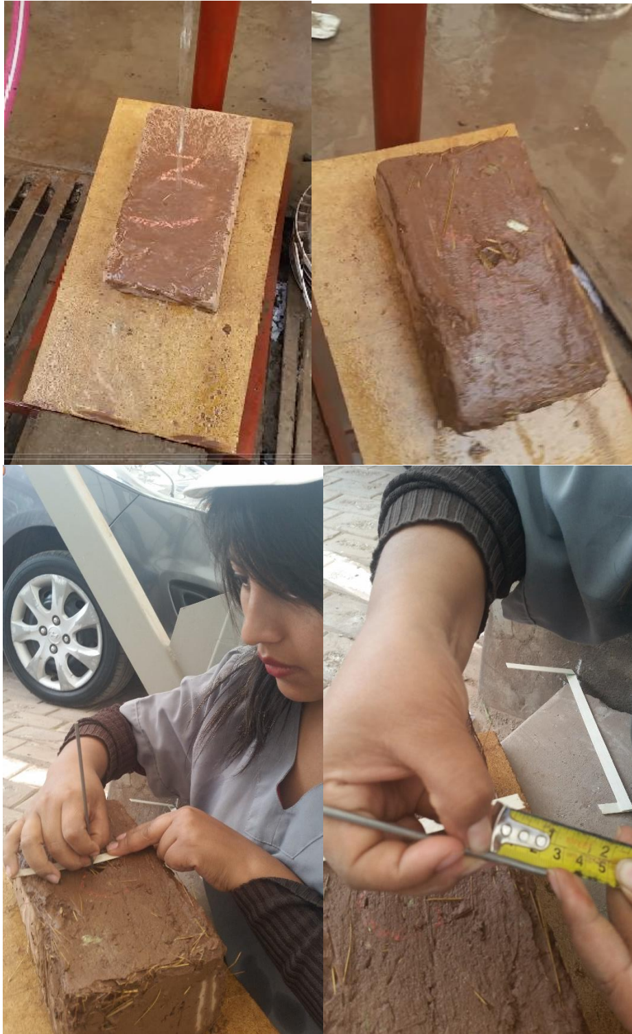
Oquedad y Medida de Oquedad después del Ensayo de Erosión Acelerada de Swinburne.
