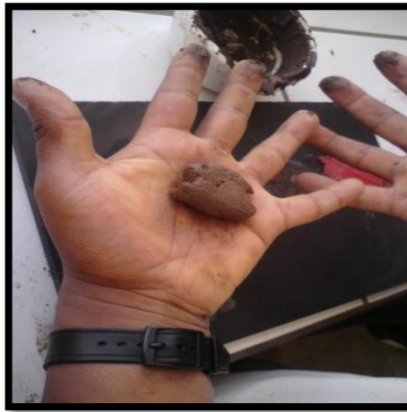
Figura N° 80: Amasado del Suelo Para Límite Plástico Fuente propia.
