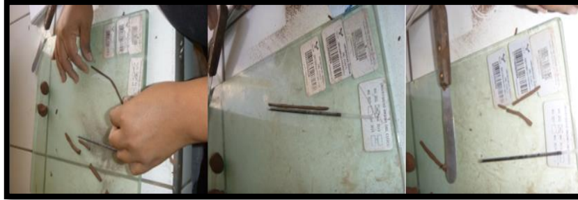
Figura N° 82: Límite Plástico del Suelo Fuente propia.
