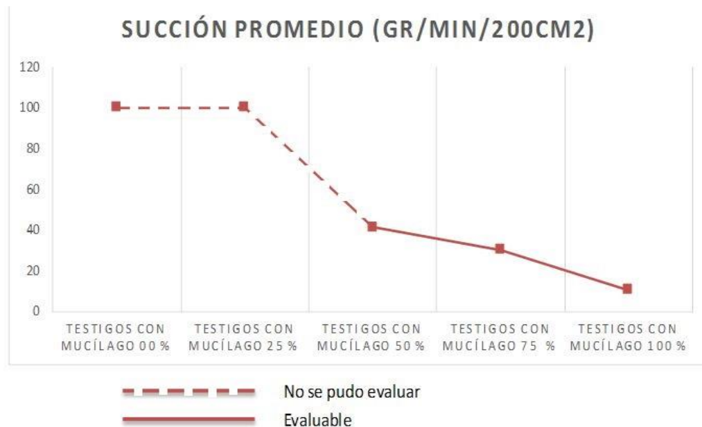
Figura N° 132: Curva de Variación de los Valores de Absorción de Testigos con Diferentes Porcentajes de Mucílago. Fuente propia.
