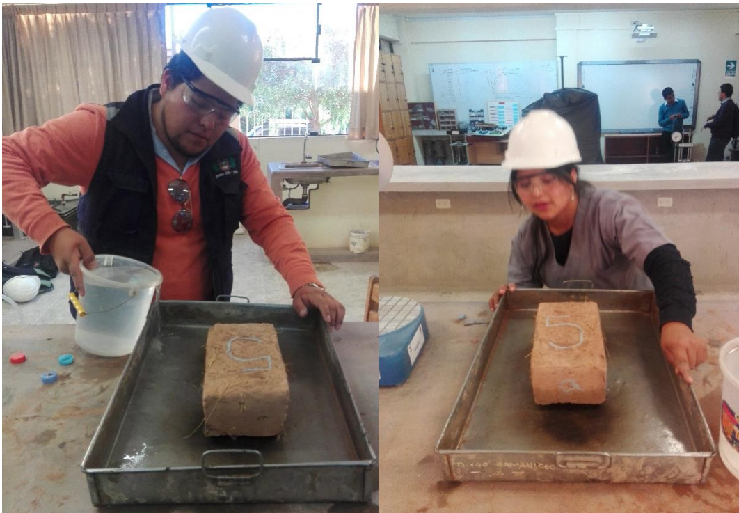
Ensayo de Succión en adobes.
