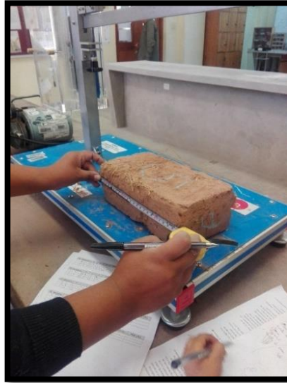
Figura N° 100: Medida de los Costados del Adobe. Fuente propia.
