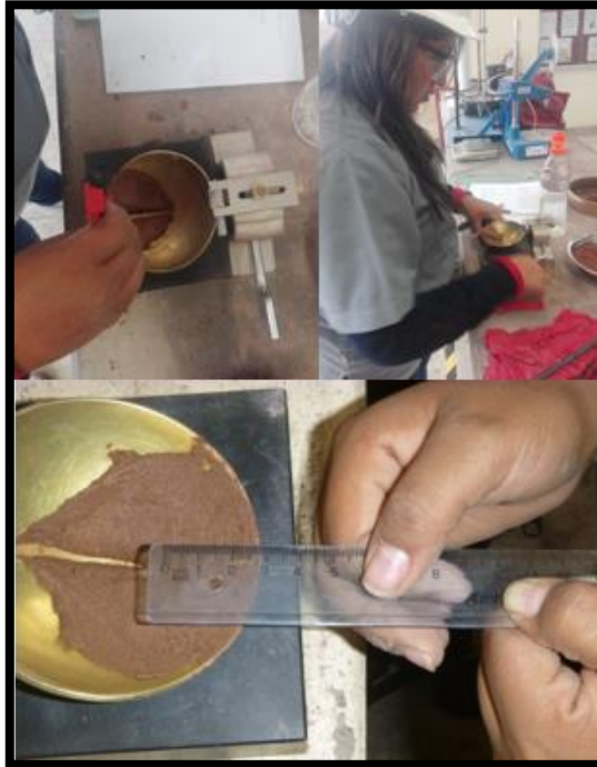
Figura N° 78: Prueba de Copa de Casa Grande Fuente propia.
