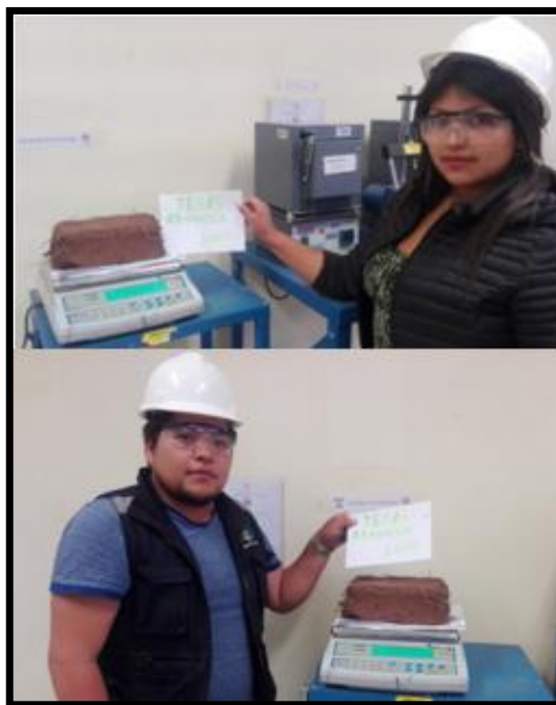
Figura N° 105: Peso de los Especímenes Después de los 5 Minutos Recomendados. Fuente propia.
