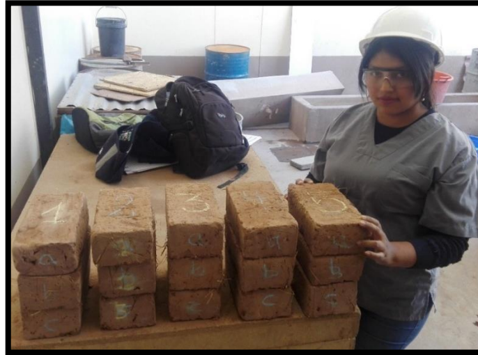
Figura N° 102: Enfriar las Unidades de Adobes en Espacios Abiertos Después de Extraerlos del Horno. Fuente propia.
