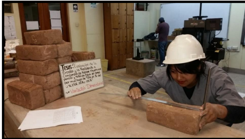
Figura N° 98: Medida de Adobes de las Superiores e Inferiores Caras Fuente propia.
