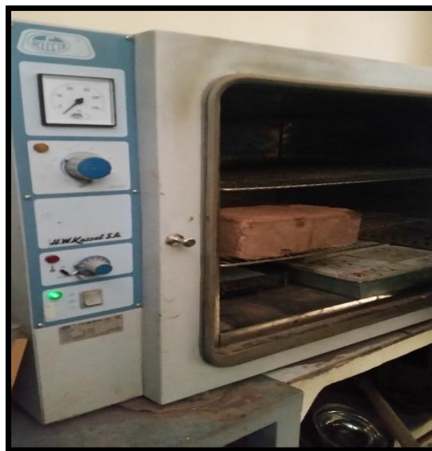
Figura N° 106: Secado de las Especímenes de Adobes Durante 24 hrs. Fuente propia.
