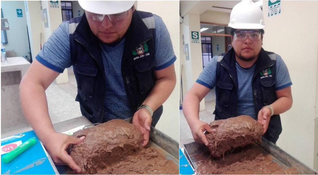
Desintegración de adobes en el ensayo de Absorción.
