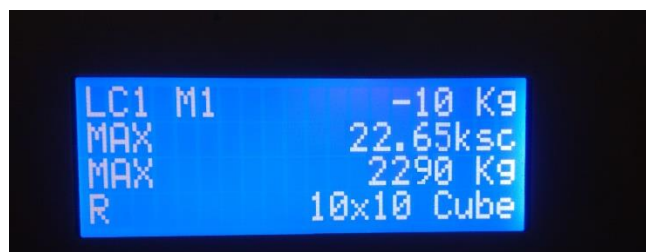
Figura N° 114: Resultado a los 30 días de la Fuerza a la Compresión de un Adobe con 100% de Mucilago de Tuna. Fuente propia.
