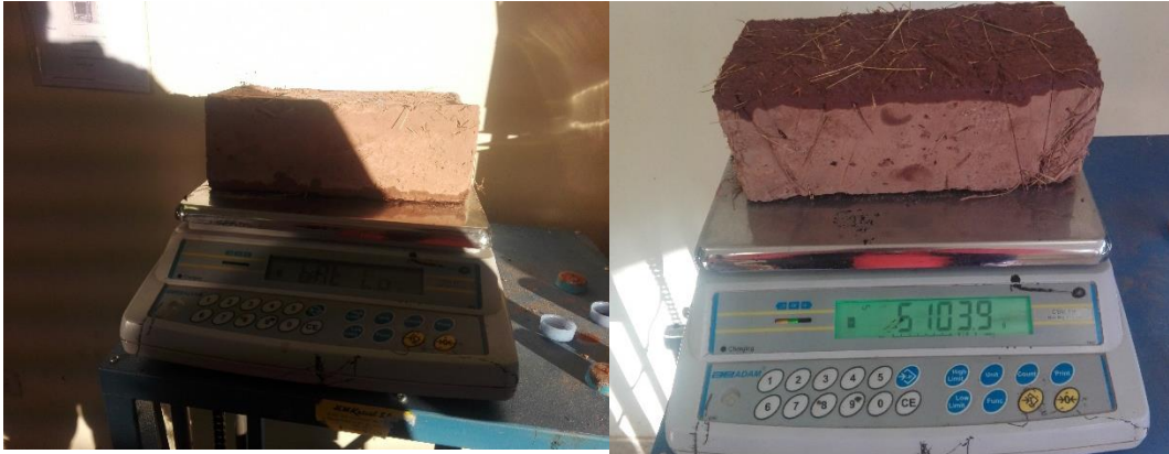
Peso de Adobes en el ensayo de Succión.
