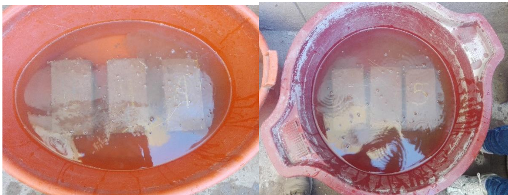
Ensayo de Absorción en Adobes
