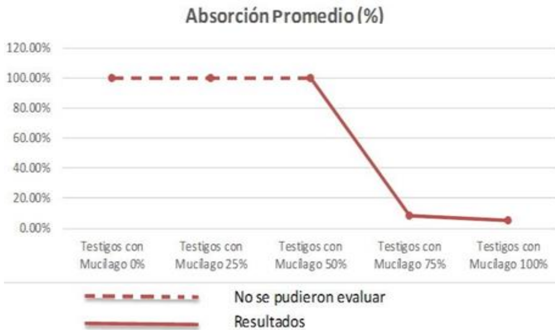
Figura N° 131: Curva de Variación de los Valores de Absorción de Testigos con Diferentes Porcentajes de Mucílago.
