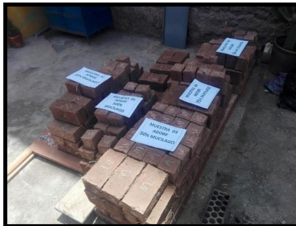
Figura N° 115: Selección de los Adobes de Forma Aleatoria para el Ensayo de SAET Fuente propia.
