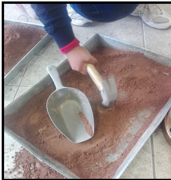
Figura N° 74: Destrucción de la Estructura Original del Suelo. Fuente propia.
