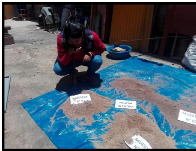
Figura N° 64: Prueba Olfativa de los Suelos Fuente propia
