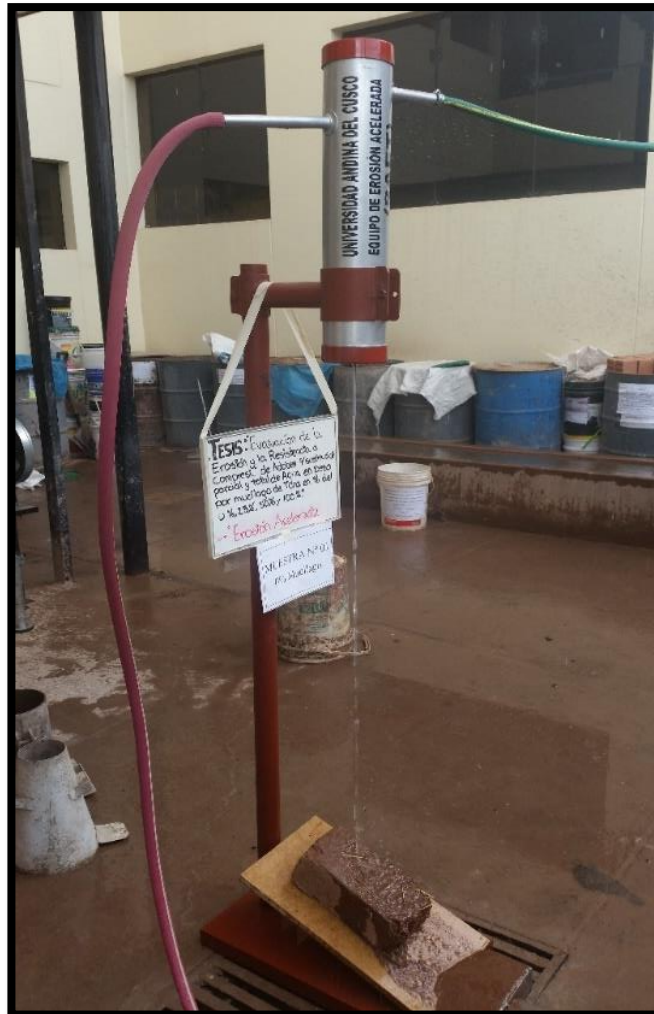
Figura N° 51: La Construcción del Equipo de Ensayo de Erosión Acelerada Swinburne (SAET) Fuente propia.
