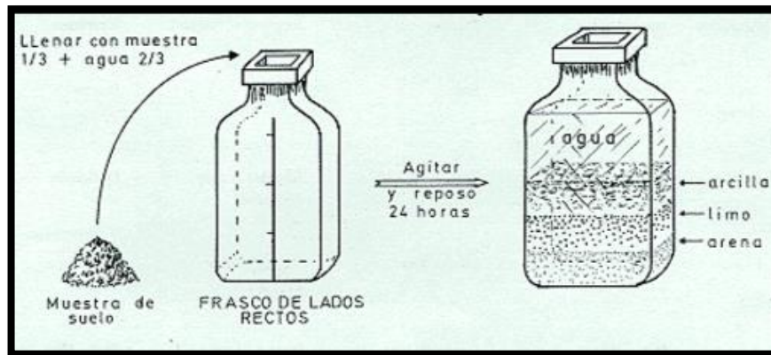
Figura N° 35: Prueba de la Botella. Recuperado de “Google”
