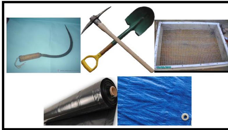
Figura N° 8: Instrumentos Para Elaborar Adobes. Recuperado de “Google”
