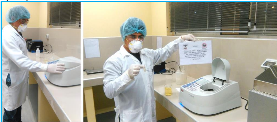
Figura 40: Proceso de lectura de la concentración de bacterias mediante un espectrofotómetro.
