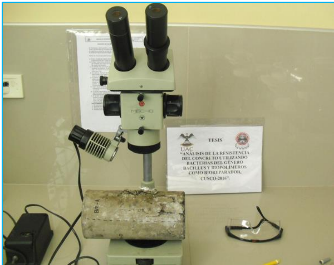
Figura 76: Equipo para observar la formación de carbonato de calcio.
