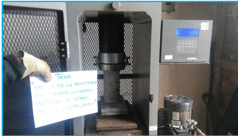
Figura 73: Ensayo de compresión.
