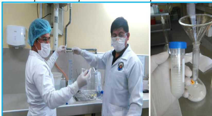
Figura 60: Re suspensión de esporas bacterianas en probeta de 1000 mL.
