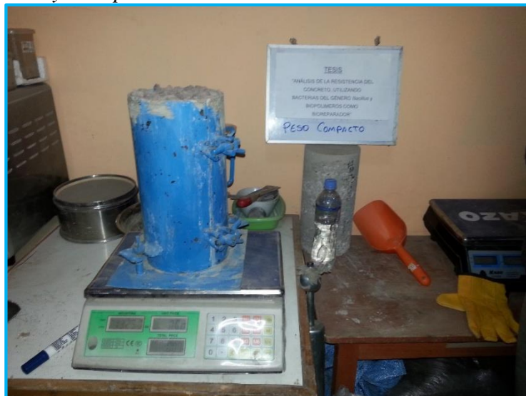
Figura 54: Ensayo del peso unitario.
