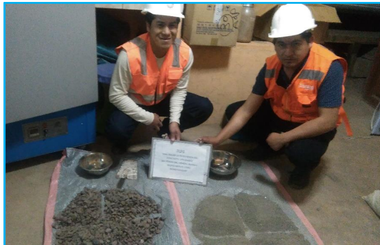
Figura 47: Cuarteo de los agregados
