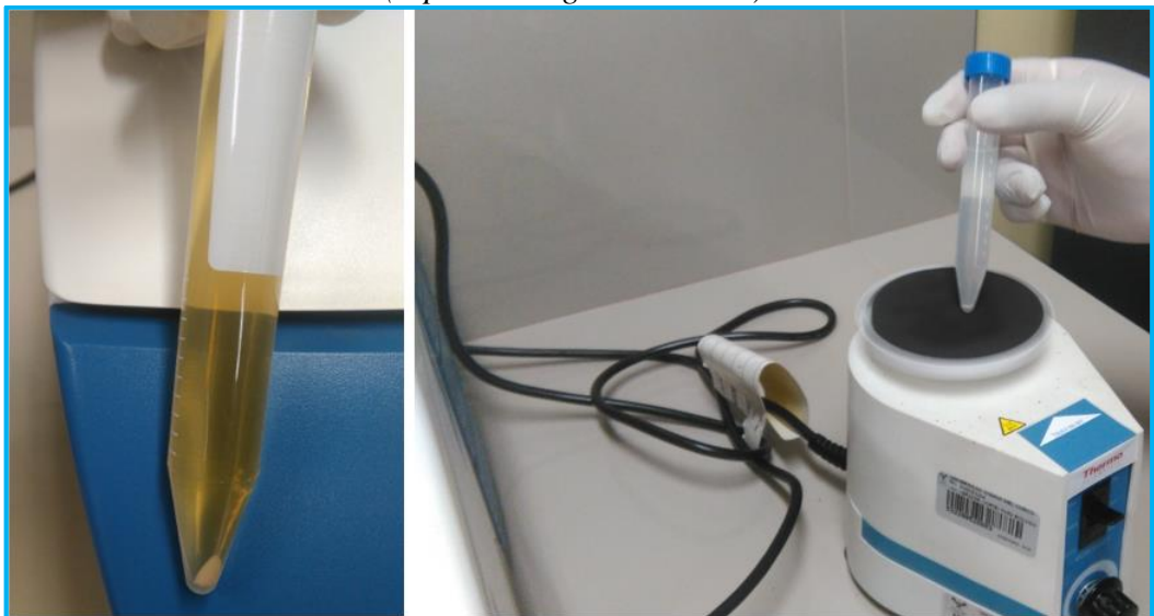
Figura 44: Proceso de disolución (esporas + agua destilada).
