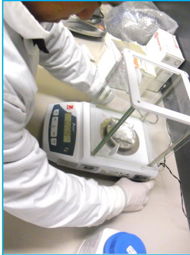
Figura 17: Proceso de calibración de la balanza analítica.
