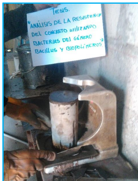
Figura 72: Refrentado de testigos de concreto.
