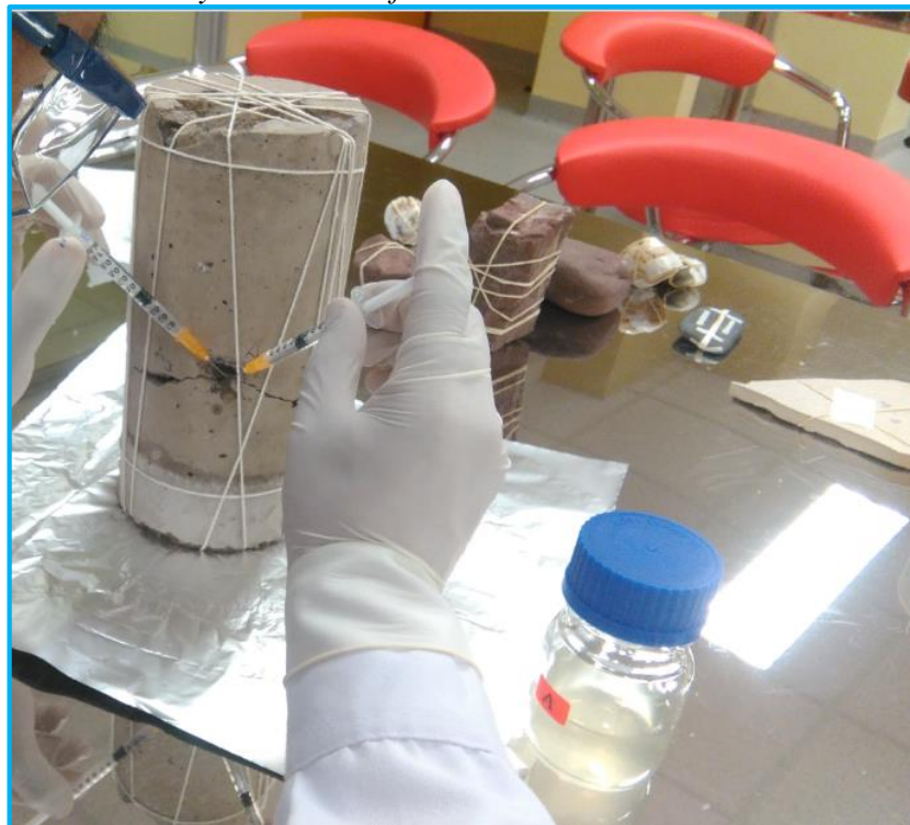
Figura 67: Proceso de inyección en la fisura del concreto.
