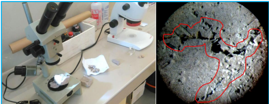
Figura 74: Observación mediante un estereoscopio, la formación de cristales de carbonato de calcio.
