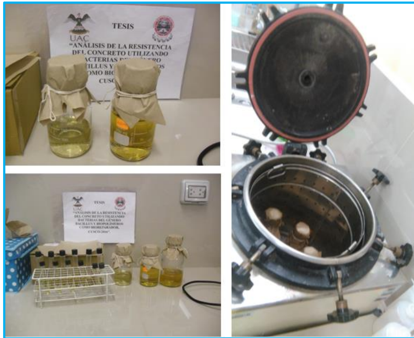
Figura 23: Esterilización mediante autoclave.
