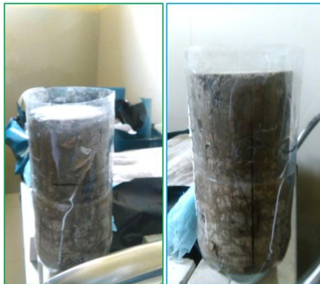
Figura 65: Aplicación mediante el curado con 200 mL de solución A y B_N + 200\text{ mL} de agua destilada.
