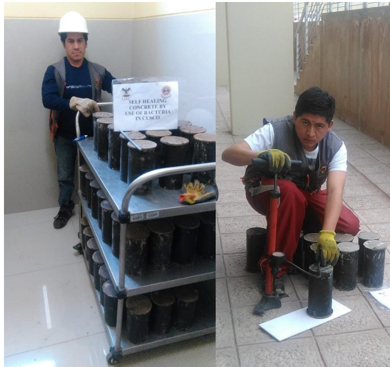
Figura 69: Desmolde de los testigos de concreto.
