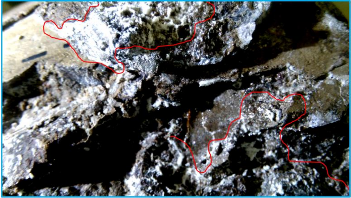
Figura 77: Observación a 2x. de la formación de carbonato de calcio mediante un estereoscopio.
