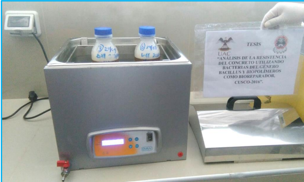
Figura 42: Cambio de temperatura para formar esporas.
