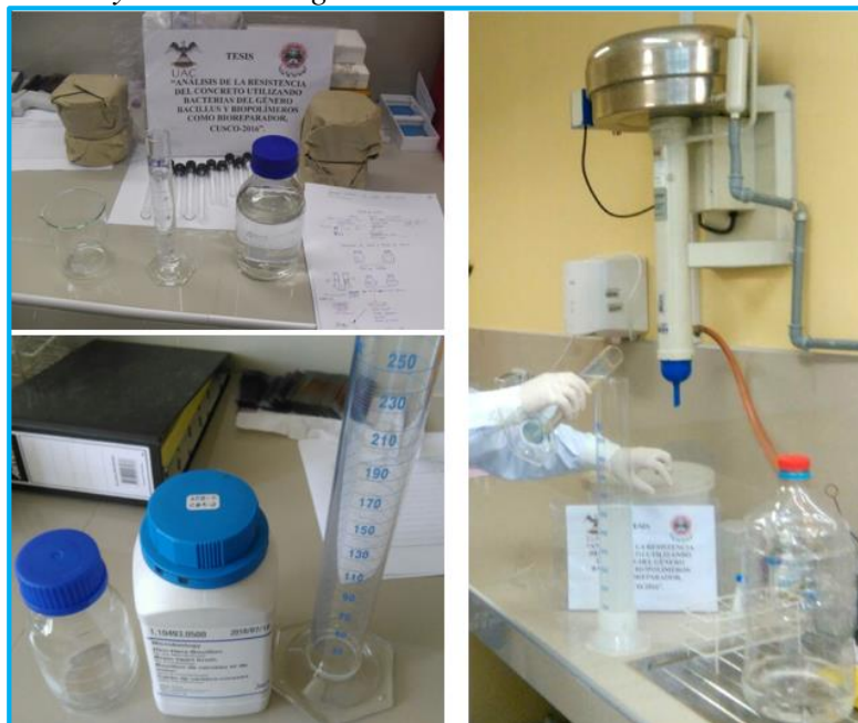
Figura 20: Preparación y medida de agua destilada.
