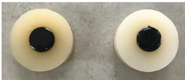
Figura 3.29 – Muestras de Ligante Asfáltico de 25 mm.
