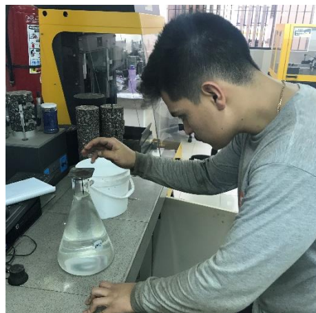
Figura 3.48 – Calibración del Matraz.
