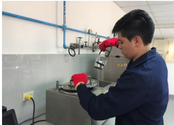
Figura 3.33. – VDO para extraer el aire atrapado en el PAV.
