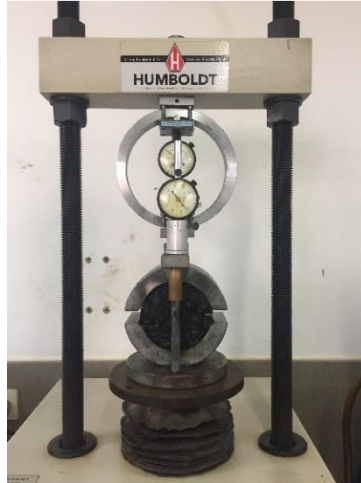
Figura 3.45. – Ensayo Marshall Estabilidad y Flujo.
