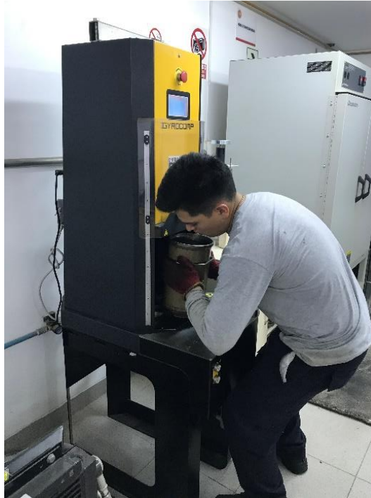
Figura 3.55 – Colocado del molde con muestra en el compactador giratorio.
