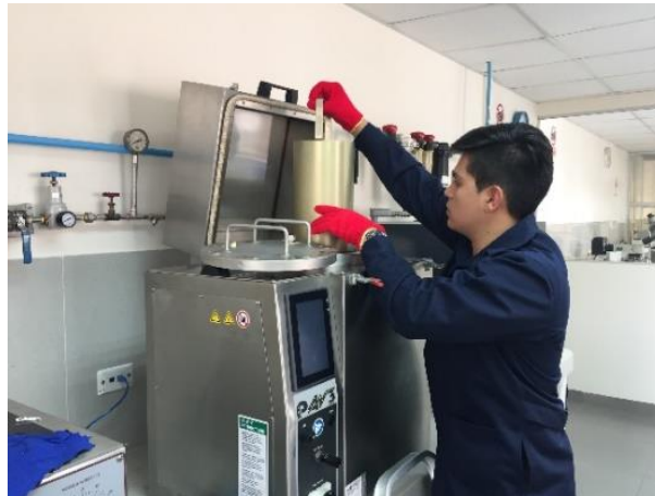
Figura 3.32 – Ingreso a horno de Envejecimiento al vacío PAV
