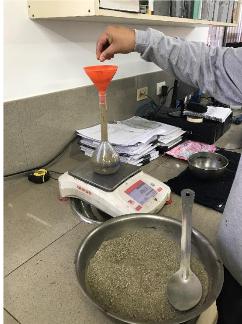
Figura 3.8 – vertido del agregado en la fiola de 500 ml.
