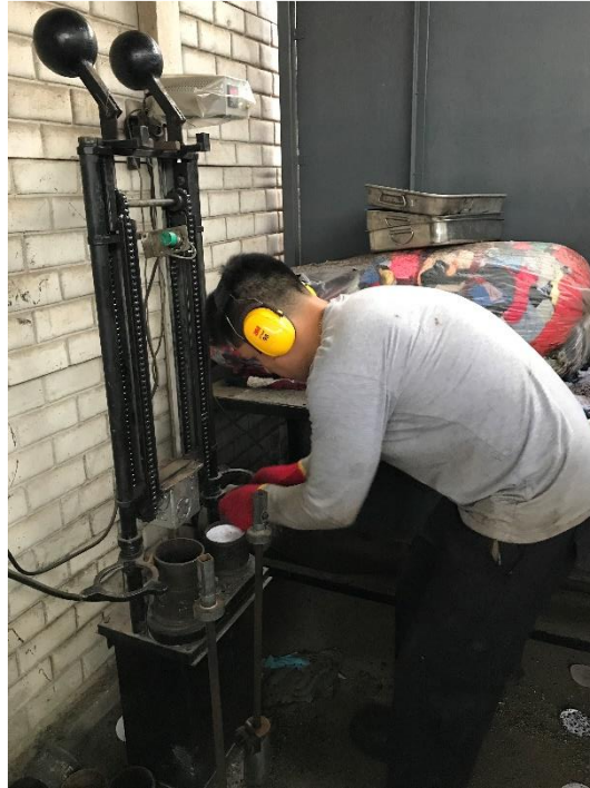
Figura 3.43 – Obtención de briqueta método Marshall.
