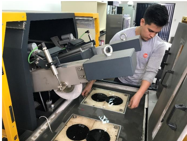
Figura 3.58 – Colocación de cuerpos de prueba al Hamburg Wheel track.
