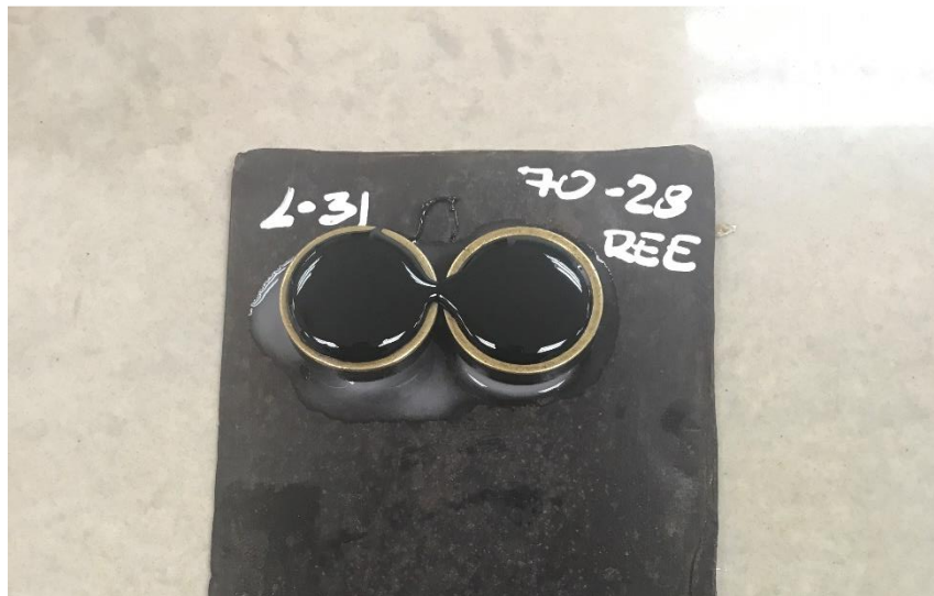
Figura 3.17 – Muestras para Punto de Ablandamiento con ligero excedente para enrasar.
