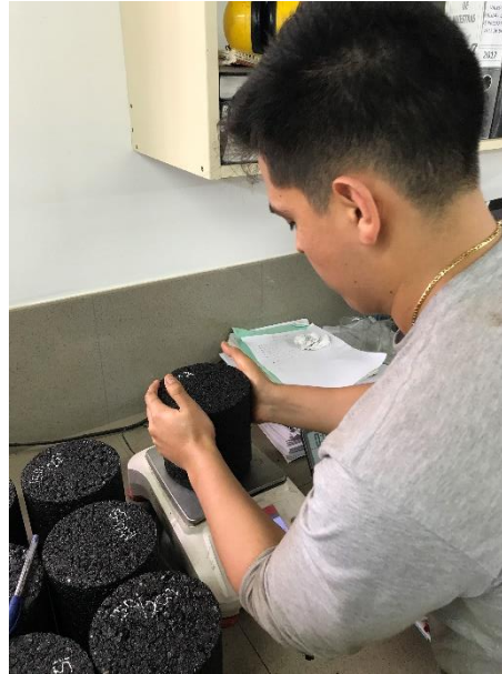
Figura 3.53 – Obtención de Peso Superficialmente Seco.
