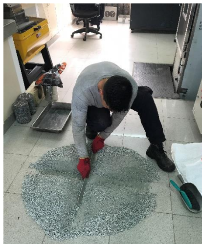
Figura 3.2: Cuarteo de los Agregados de la cantera “Supermix” – Cusco.
