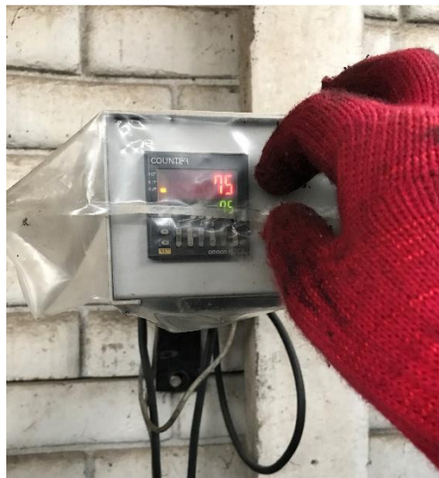
Figura 3.42 – 75 golpes para la producción de nuestras briquetas.
