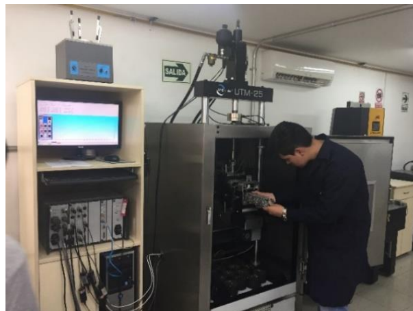
Figura 3.65. – Ingreso de viga a cámara de fatiga.
