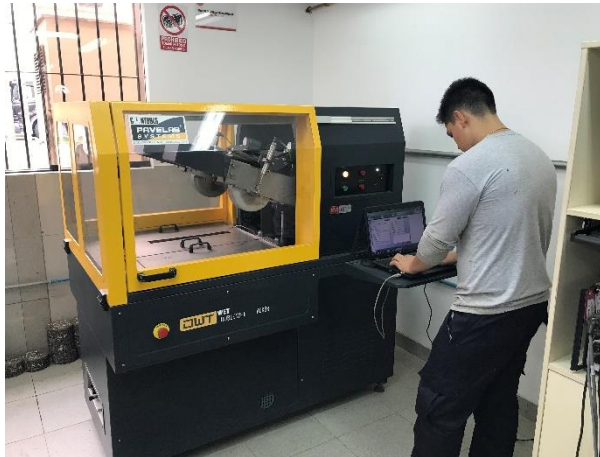
Figura 3.61. – Ingreso de datos al software del Hamburg Wheel track.
