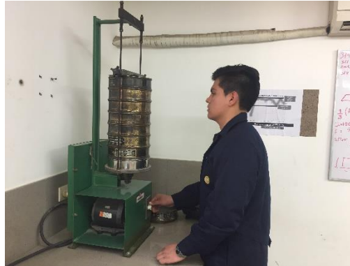
Figura 3.5 – Tamizado mecánico agregado fino.
