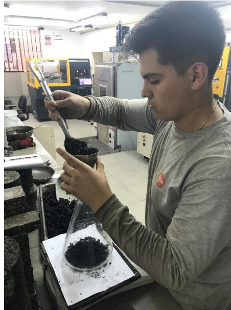
Figura 3.49 – Vertimiento de la mezcla dentro del matraz.
