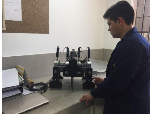
Figura 3.64. – Equipo de resistencia a fatiga 4 puntos de ensayo.
