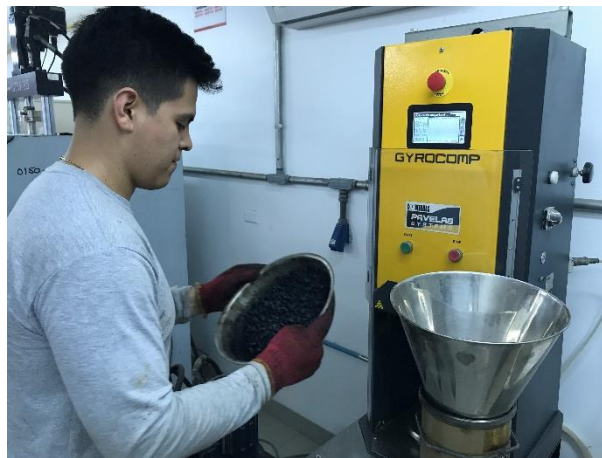
Figura 3.54 – Vertimiento de mezcla dentro del molde de compactación SUPERPAVE.
