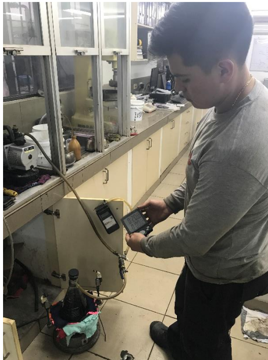
Figura 3.50 – Extracción del aire atrapado, a 30 mmHg durante 20 min.
