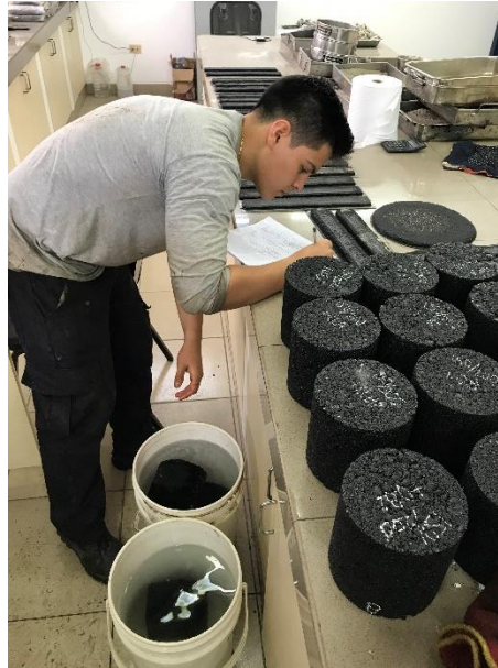
Figura 3.51 – Sumergimiento de briquetas para su saturación.
