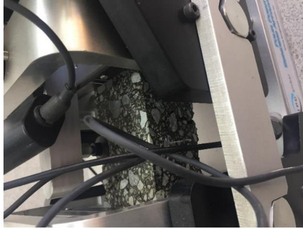
Figura 3.66. – Falla por fatiga de viga.
