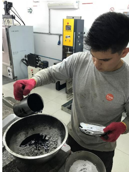
Figura 3.38 – Inclusión del ligante asfáltico a la mezcla de los agregados.
