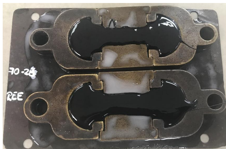
Figura 3.22. – Muestras de Ensayo de Recuperación elástica lineal.
