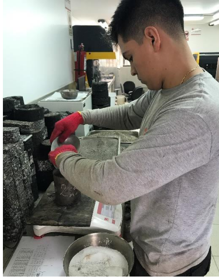
Figura 3.36 – Proceso De Pesado De Los Agregados Pétreos, Tanto Gruesos, Como Finos Y El Filler
