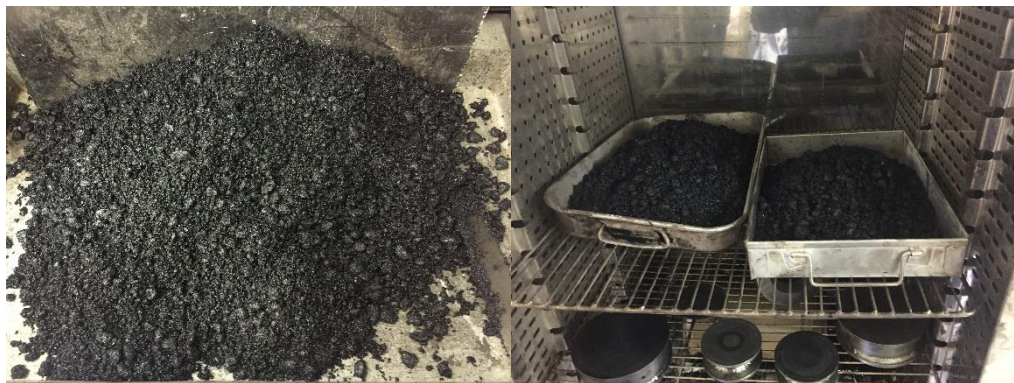
Figura 3.40. – Preparación de mezcla y horno de curado.
