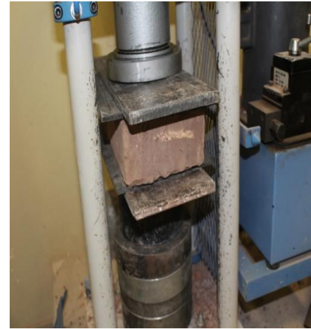
FIGURA 94: SE SOMETE LA PRUEBA HASTA QUE LA MUESTRA FALLE TOTALMENTE
