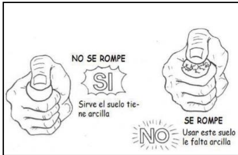
FIGURA 6 : PRUEBA “PRESENCIA DE ARCILLA O RESISTENCIA SECA”
