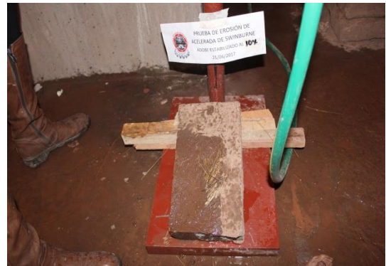
FIGURA 178 : UNIDADES DE ADOBE ESTABILIZADO AL 10% DURANTE EL ENSAYO
