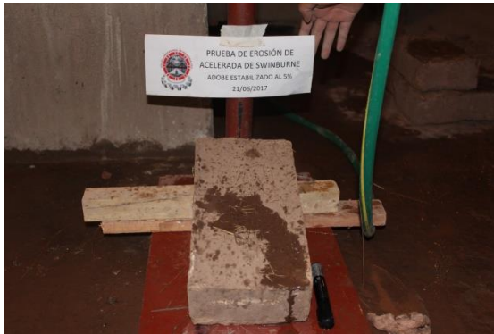
FIGURA 175 : UNIDADES DE ADOBE ESTABILIZADO AL 5% DURANTE EL ENSAYO
