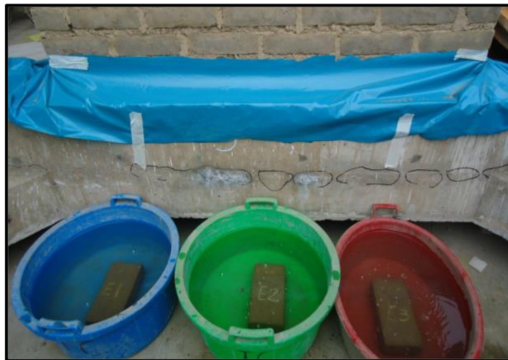
FIGURA 16 : ENSAYO DE ABSORCIÓN.
