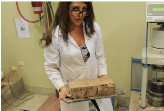
FIGURA 199 : UNIDAD DE ADOBE DESPUÉS DEL ENSAYO
