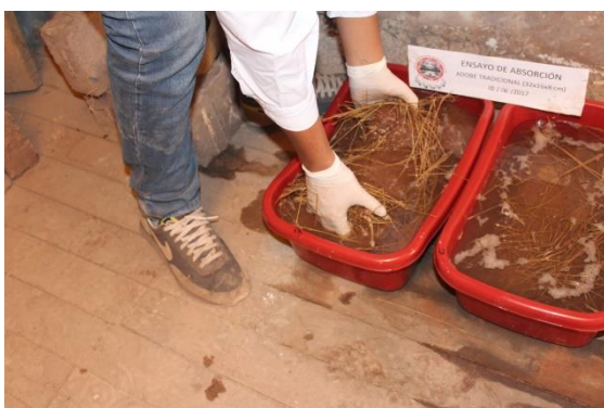
FIGURA 159 : UNIDAD DE ADOBE TRADICIONAL NO RESISTIÓ EL ENSAYO DE ABSORCIÓN
