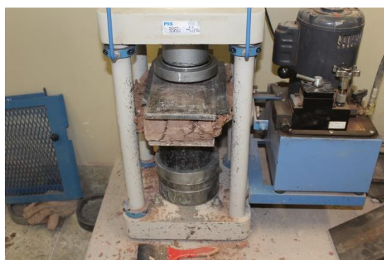
FIGURA 191 : UNIDAD DESPUÉS DEL ENSAYO DE COMPRESIÓN
