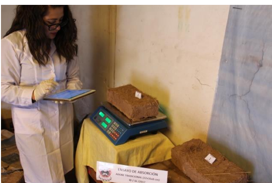
FIGURA 155 : PESO SECO DE LAS MUESTRAS DE ADOBE.
