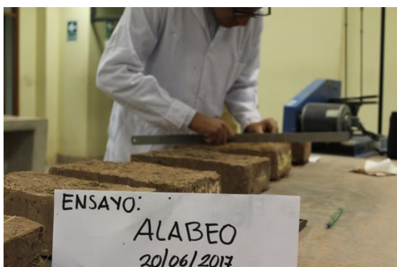
FIGURA 153 : MEDICIÓN DEL ALABEO EN LAS UNIDADES DE ADOBE
