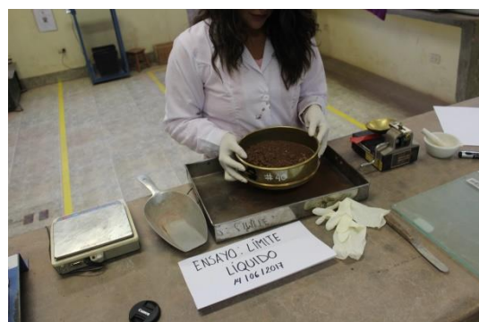
FIGURA 136 : ENSAYO DE LIMITE LIQUIDO, LA MUESTRA DEBE PASAR EL TAMIZ #40
