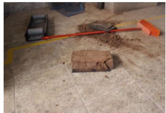
FIGURA 200 : UNIDAD DE ADOBE DESPUÉS DEL ENSAYO
