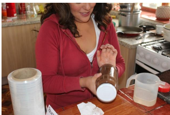
FIGURA 129 : AGITAMOS LA BOTELLA PARA QUE SE MEZCLEN TODAS LAS PARTÍCULAS DE LA MUESTRA
