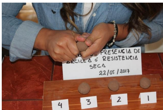
FIGURA 135 : LAS MUESTRAS NO SE ROMPEN CON LOS DEDOS DE LAS MANOS.
