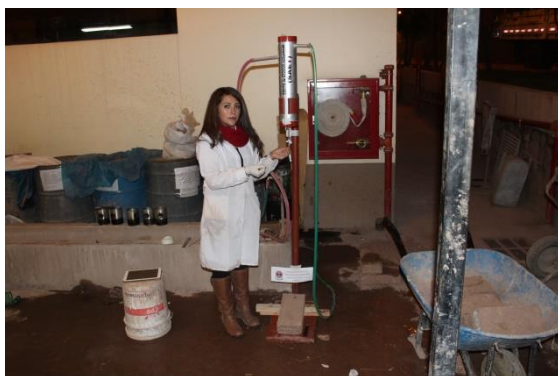
FIGURA 173 : ENSAYO A LAS UNIDADES DE ADOBE ESTABILIZADO AL 5 %
