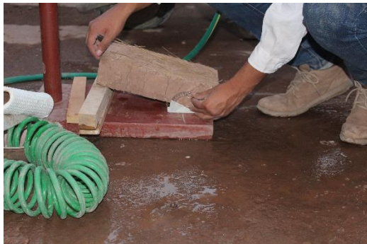
FIGURA 87: COLOCAR LA UNIDAD EN UN ANGULO DE 27°
