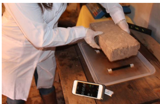
FIGURA 165 : COLOCADO DE LA UNIDAD PARA SER SOMETIDO AL ENSAYO DE SUCCIÓN
