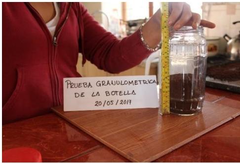
FIGURA 34: LLENAR LA BOTELLA HASTA LA MITAD CON MATERIA PRIMA
