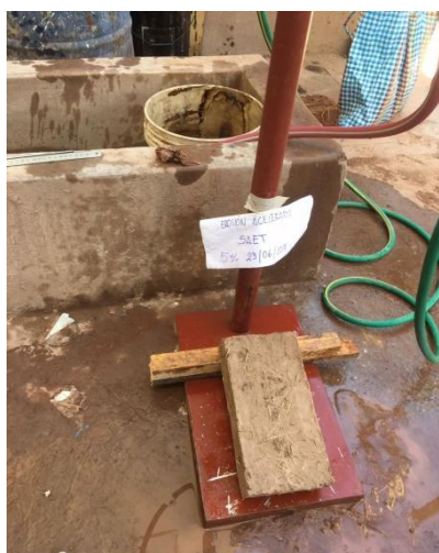
FIGURA 185 : UNIDAD DE ADOBE AL 5% ANTES DEL ENSAYO
