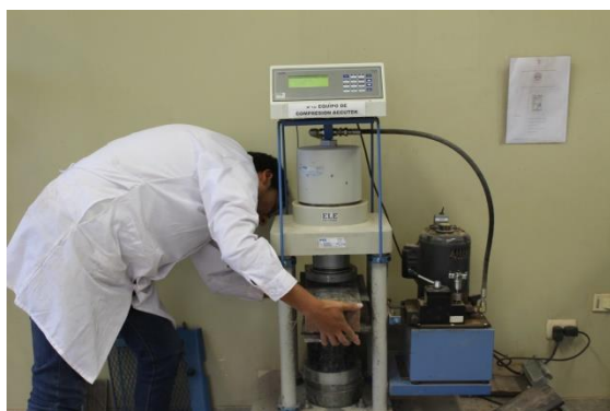
FIGURA 189 : ENSAYO DE RESISTENCIA A LA COMPRESIÓN, PREPARACIÓN DE LA MUESTRA A LA MAQUINA DE COMPRESIÓN
