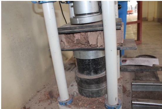
FIGURA 197 : UNIDAD DE ADOBE ESTABILIZADO AL 10% AL MOMENTO DE SU FALLA TOTAL
