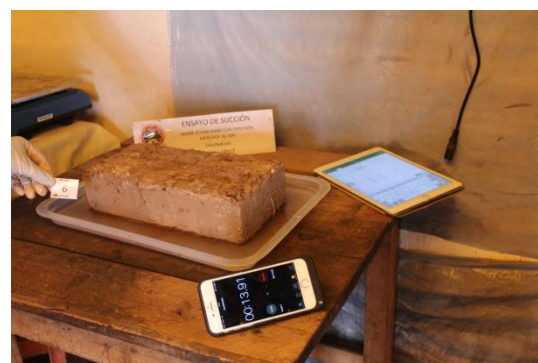
FIGURA 166 : UNIDAD SIENDO ENSAYADA POR EL LAPSO DE 1 MINUTO
