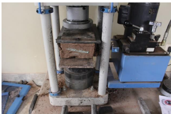
FIGURA 195 : UNIDAD DE ADOBE ESTABILIZADO AL 10% SIENDO ENSAYADA
