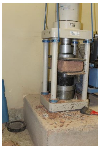
FIGURA 193 : UNIDAD DE ADOBE ESTABILIZADO AL 5% SIENDO ENSAYADA
