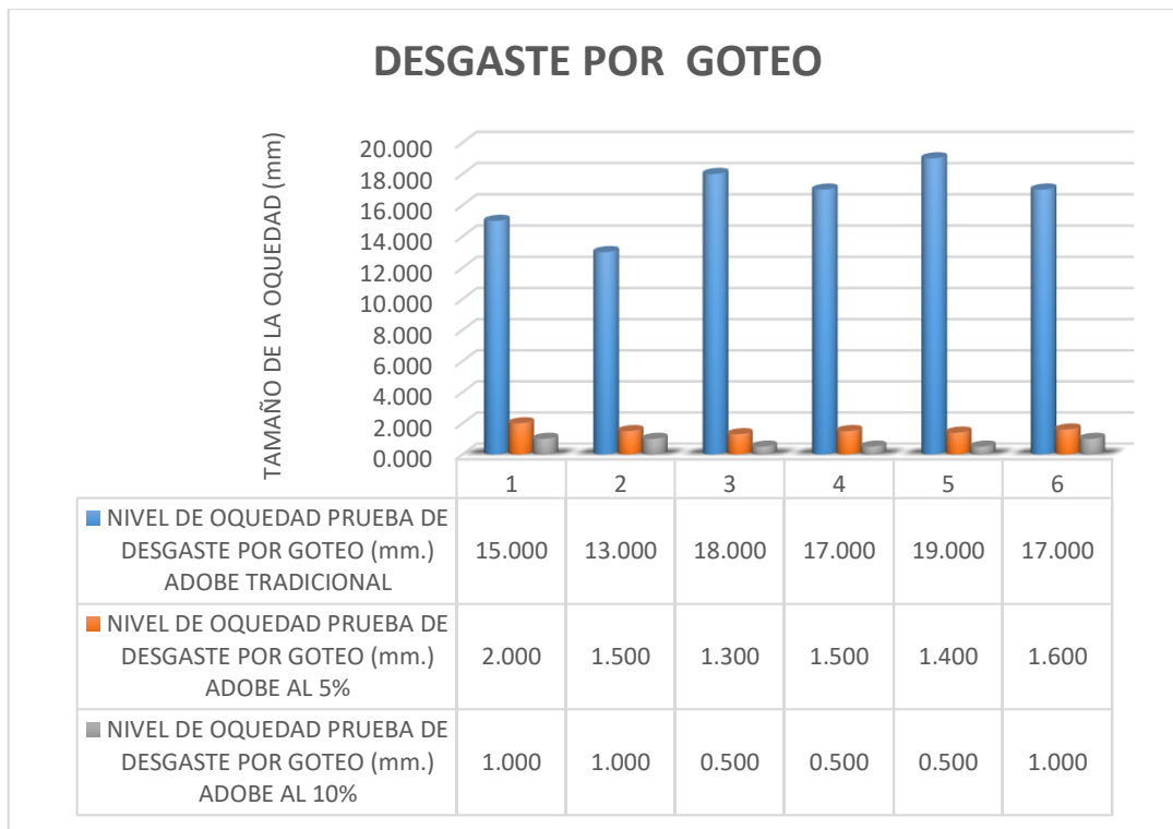
FIGURA 105 : RESULTADOS - ENSAYO DE DESGASTE POR GOTEO
