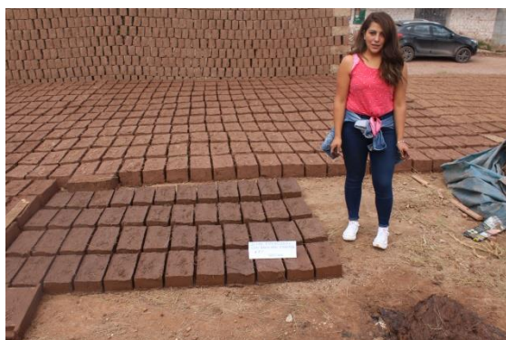
FIGURA 119 : UNIDADES DE ADOBE CON EMULSIÓN ASFÁLTICA AL 5% TERMINADAS
