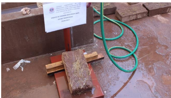
FIGURA 181 : ENSAYO DE EROSIÓN ACCELERADA SAET
