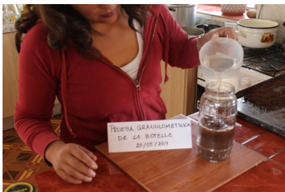
FIGURA 127 : ADICIÓN DE AGUA AL MATERIAL
