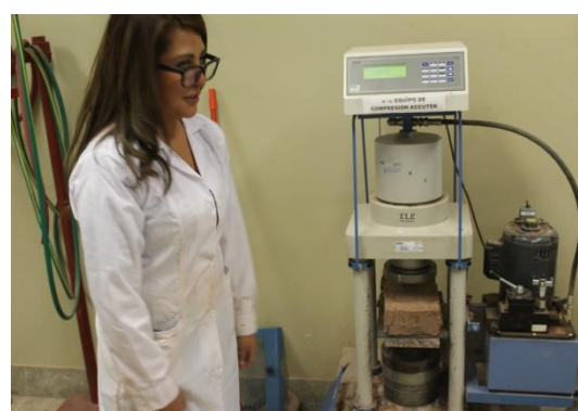
FIGURA 192 : UNIDAD DE ADOBE ESTABILIZADO AL 5% SIENDO ENSAYADO
