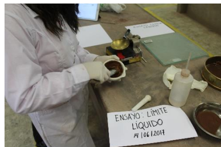
FIGURA 51: ADICIÓN DE AGUA
