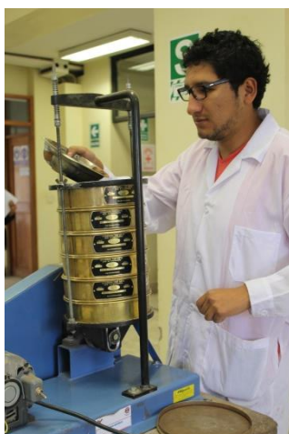
FIGURA 147 : AGREGANDO EL MATERIAL PREVIAMENTE PESADO
