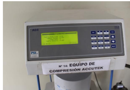
FIGURA 198 : CARGA MÁXIMA QUE SOPORTO LA UNIDAD DE ADOBE
