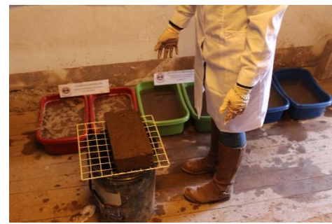
FIGURA 80: DEJAR ESCURRIR EL EXCESO DE AGUA
