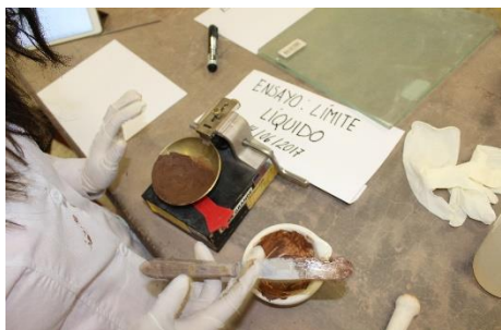
FIGURA 52: COLOCAR LA MUESTRA HÚMEDA EN LA CUCHARA DE CAS GRANDE
