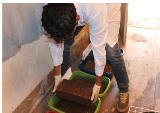
FIGURA 160 : UNIDAD DE ADOBE ESTABILIZADO AL 5% RETIRADO PARA SER PESADO.
