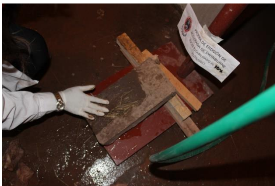
FIGURA 179 : UNIDADES DE ADOBE ESTABILIZADO AL 10% DESPUÉS DEL ENSAYO
