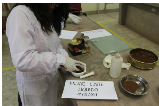
FIGURA 137 : MEZCLADO CON LA HUMEDAD ADECUADA PARA EL ENSAYO
