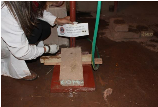
FIGURA 177 : UNIDADES DE ADOBE ESTABILIZADO AL 10% ANTES DEL ENSAYO
