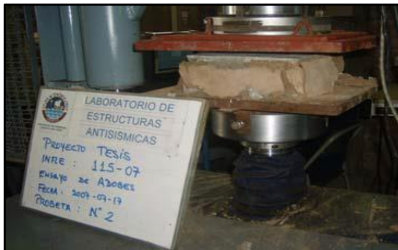
FIGURA 14 : ENSAYO DE RESISTENCIA A LA COMPRESIÓN.
