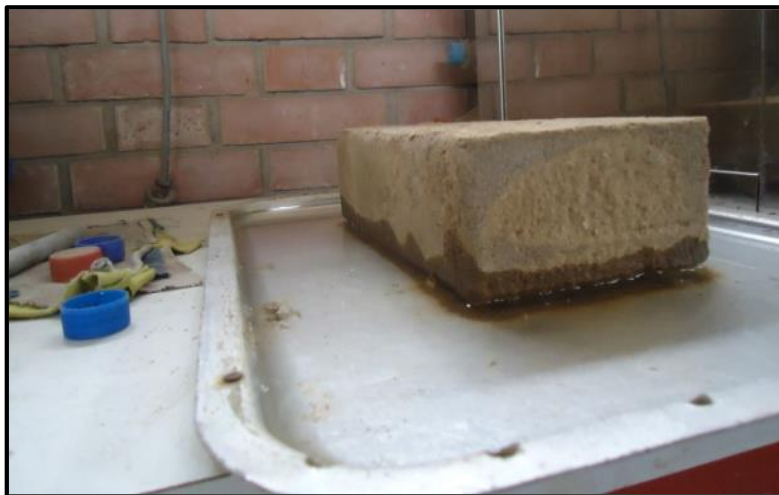
FIGURA 15 : ENSAYO DE SUCCIÓN.
