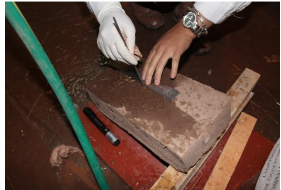
FIGURA 176 : UNIDADES DE ADOBE ESTABILIZADO AL 5% CON UN MÍNIMO NIVEL DE OQUEDAD
