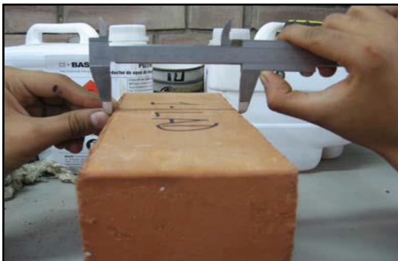
FIGURA 13 : ENSAYO DE VARIABILIDAD DIMENSIONAL.
