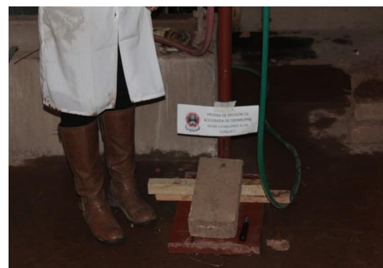
FIGURA 174 : ENSAYO A LAS UNIDADES DE ADOBE ESTABILIZADO AL 5 %
