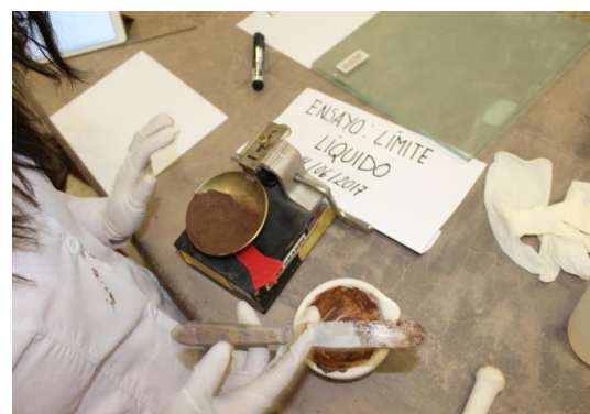
FIGURA 138 : COLOCADO DE LA MUESTRA EN LA CUCHARA DE CASAGRANDE
