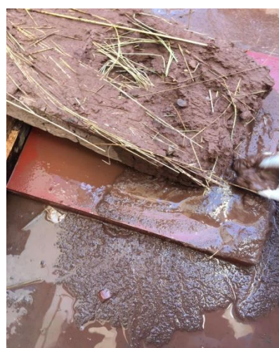
FIGURA 184 : UNIDAD DE ADOBE DESPUÉS DEL ENSAYO
