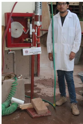
FIGURA 169 : ENSAYO DE DESGASTE POR GOTEO
