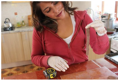
FIGURA 41: COLGAR LA CINTA HASTA QUE SE ROMPA
