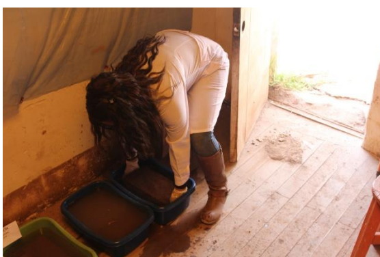
FIGURA 161 : UNIDAD DE ADOBE AL 10% RETIRADO PARA SER PESADO
