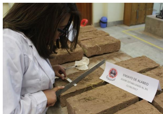
FIGURA 154 : MEDICIÓN DEL ALABEO EN LAS UNIDADES DE ADOBE
