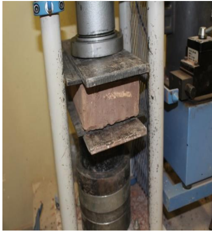
FIGURA 93: SE COLOCA LA UNIDAD A ENSAYAR A LA MAQUINAR JUNTO CON LAS LAMINAS DE NEOPRENO
