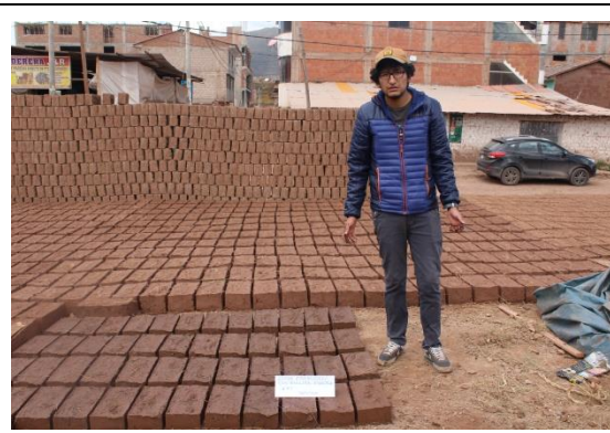
FIGURA 33 : UNIDADES DE ADOBE ESTABILIZADO AL 10 %
