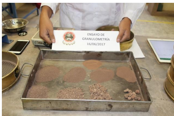
FIGURA 149 : MUESTRAS FINALES TAMIZADAS
