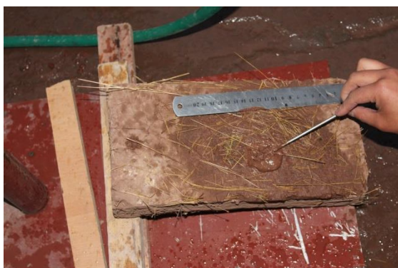
FIGURA 171 : UNIDAD DE ADOBE TRADICIONAL TRAS EL ENSAYO DE DESGASTE POR GOTEO
