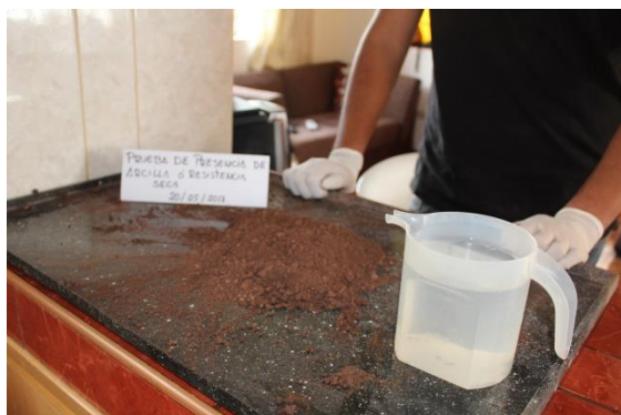
FIGURA 131 : ENSAYO DE RESISTENCIA SECA
