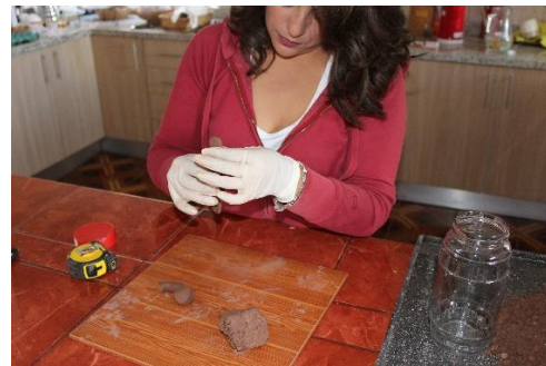
FIGURA 40: APLASTAR HASTA FORMAR LA CINTA DE 4 MM DE ESPESOR
