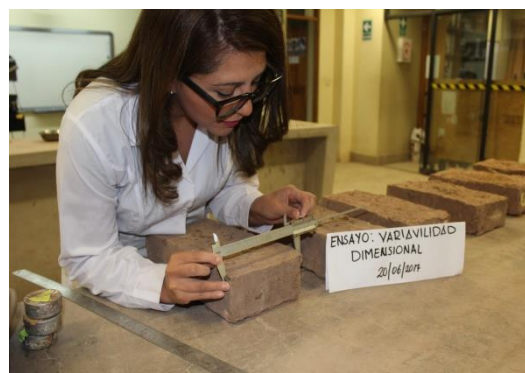
FIGURA 150 : ENSAYO DE VARIABILIDAD DIMENSIONAL, MUESTRAS DE ADOBE SIENDO MEDIDAS
