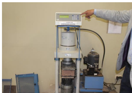
FIGURA 190 : UNIDAD SIENDO ENSAYADA CON LA MAQUINA DE COMPRESIÓN
