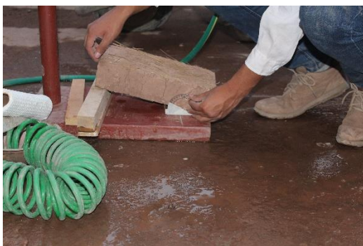
FIGURA 83: COLOCAR LA UNIDAD EN UN ANGULO DE 27°
