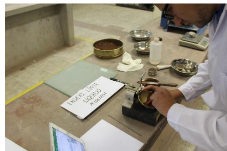
FIGURA 53: DIVIDIR LA MUESTRA CON EL RANURADOR
