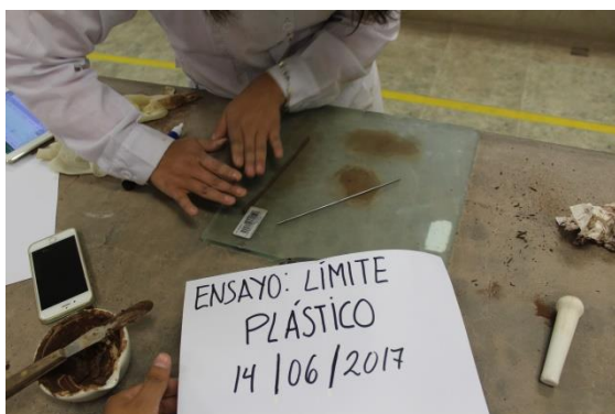
FIGURA 141 : REALIZANDO EL ROLLO HASTA ALCANZAR 03 mm.
