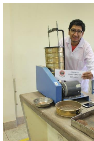
FIGURA 148 : REALIZANDO EL ENSAYO DE GRANULOMETRÍA
