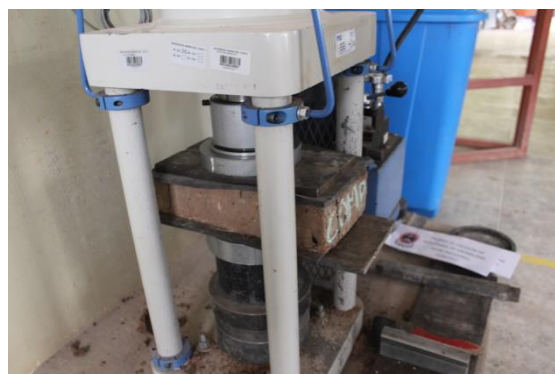
FIGURA 196 : UNIDAD DE ADOBE ESTABILIZADO AL 10% SIENDO ENSAYADA
