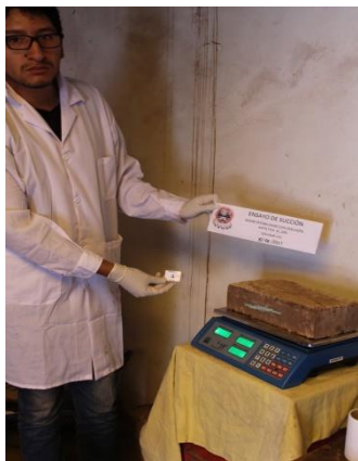
FIGURA 163 : ENSAYO DE SUCCIÓN
