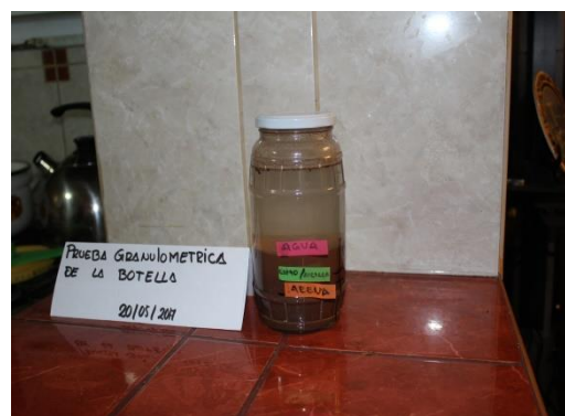
FIGURA 130 : HORAS DESPUÉS EL MATERIAL EMPIEZA A ASENTARSE DIVIDIÉNDOSE POR ESTRATOS
