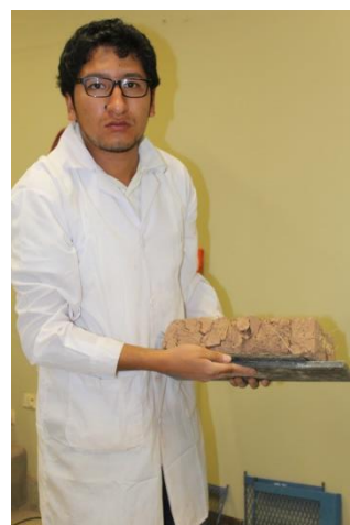
FIGURA 194 : UNIDAD DE ADOBE ESTABILIZADO AL 5% DESPUÉS DEL ENSAYO
