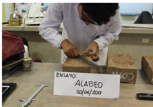
FIGURA 152 : ENSAYO DE ALABEO, MEDICIÓN DE LA CARA A DE LA UNIDAD DE ADOBE
