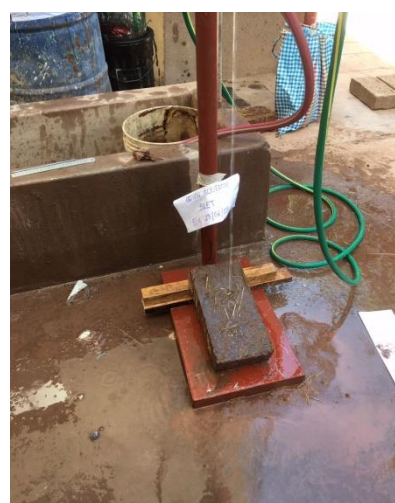
FIGURA 186 : UNIDAD DE ADOBE AL 5% DURANTE DEL ENSAYO
