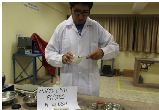
FIGURA 140 : ENSAYO DE LIMITE PLÁSTICO, MEZCLA DE LA MUESTRA CON LA HUMEDAD ADECUADA
