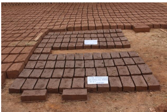
FIGURA 121 : DE ADOBE ESTABILIZADO AL 5% Y AL 10% TERMINADAS
