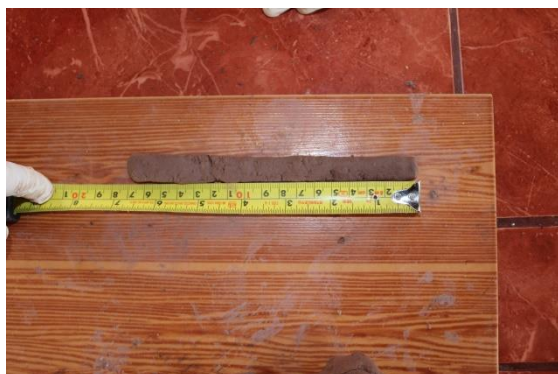
FIGURA 125 : MEDICIÓN DE LA CINTA DE BARRO
